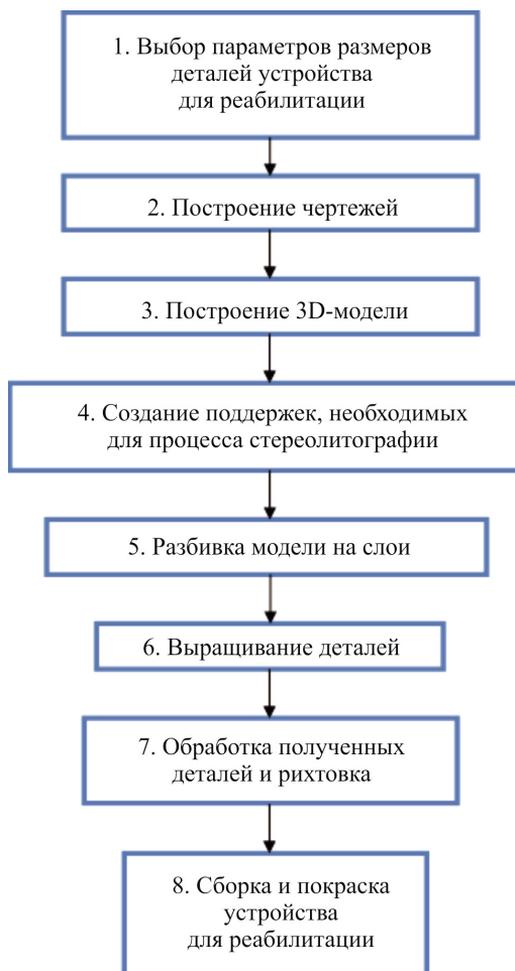
Рис. 3. Процесс изготовления устройства
