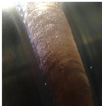
Рис. 3. Наплавленная дорожка на токе обратной полярности
