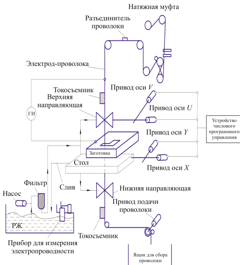
Рис. 1. Схема проволочно-вырезного электроэрозионного станка
