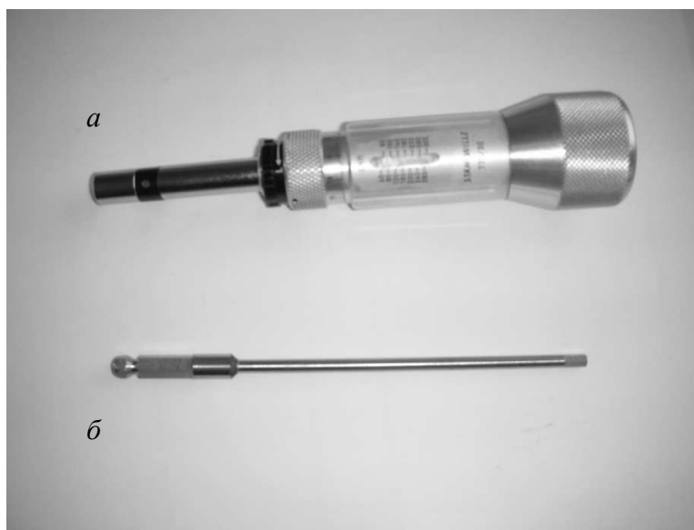
Рис. 2. Фото динамометрического ключа ( а ) и отвёртки-вставки ( б ) для установки резьбового фиксатора с дозированным моментом закручивания
