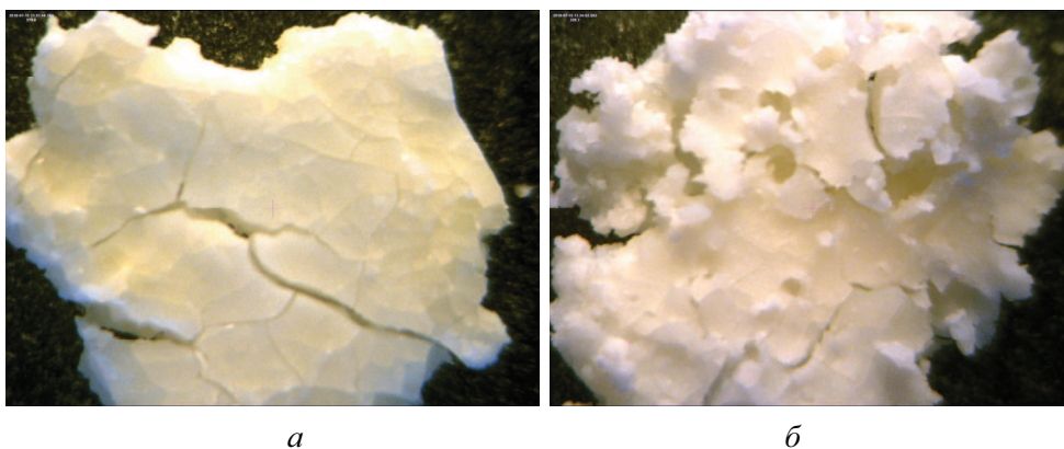
Рис. 7. Оксигидрат титана, высушенный в условиях радиационной сушки (а) и в условиях микроволнового излучения (б)
