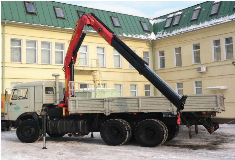
Рис. 1. Кран-манипулятор автомобильный с КМУ Palfinger PK 15500 на шасси автомобиля КамАЗ 65115
