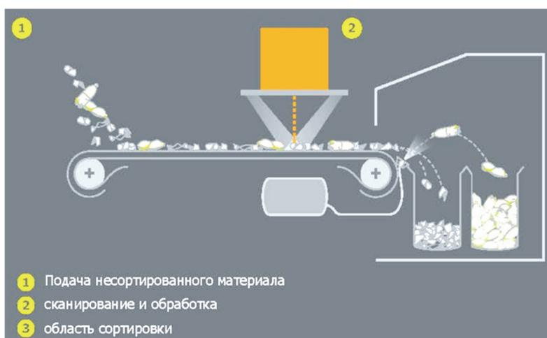
Рис. 1. Принципиальная схема оптической сортировки
