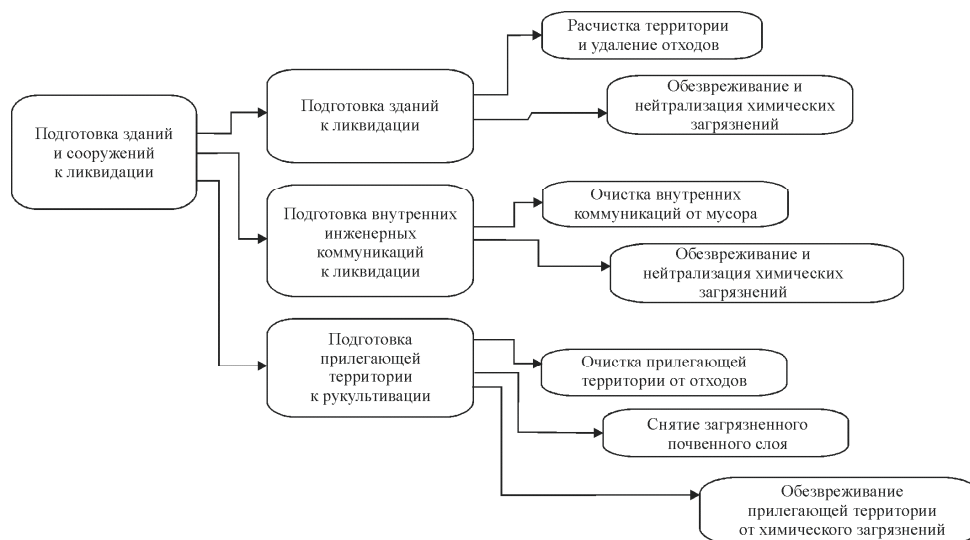
Рис. 2. Подготовка зданий и сооружений к ликвидации
