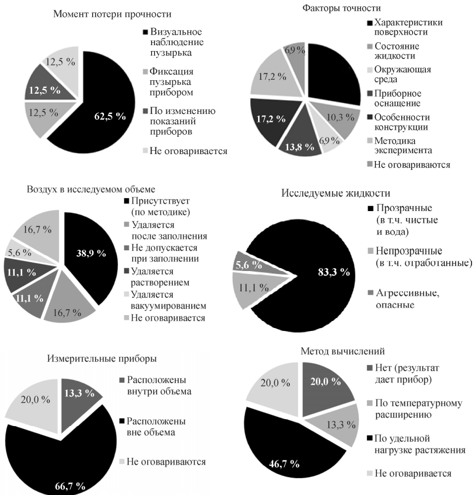
Рис. 4. Обзор основных методов исследования прочности жидкости
