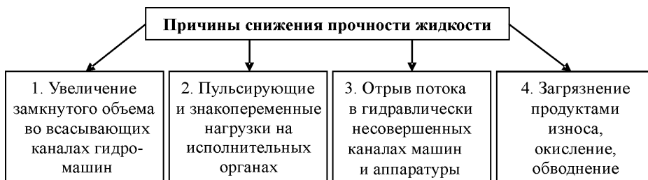
Рис. 2. Основные причины снижения прочности жидкости
