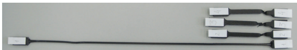
Рис. 4. Образцы из ПНД после проведения испытаний на одноосное растяжение с различными скоростями деформирования
