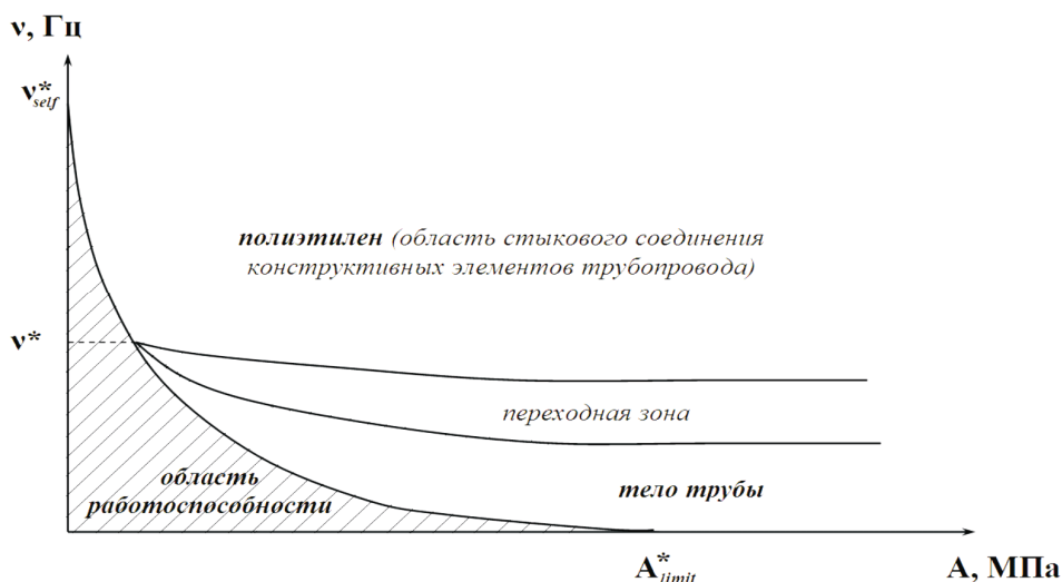
Рис. 7. Зоны разрушения полимерных армированных труб в зависимости от условий приложения нагрузки
