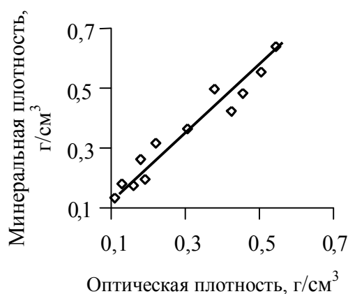
Рис. 9. Линейное приближение экспериментальных значений минеральной плотности и оптической объёмной плотности
