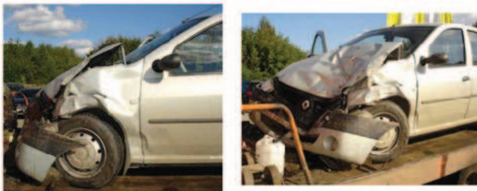
Рис. 2. Повреждения автомобиля Renault Logan после столкновения
