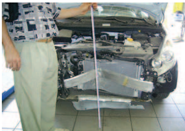
Рис. 1. Деформация автомобиля Opel Corsa
