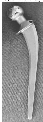
Рис. 3. Удаленная ножка эндопротеза Веллера
