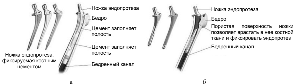
Рис. 3. Схемы цементного (а) и бесцементного (б) эндопротезирования
