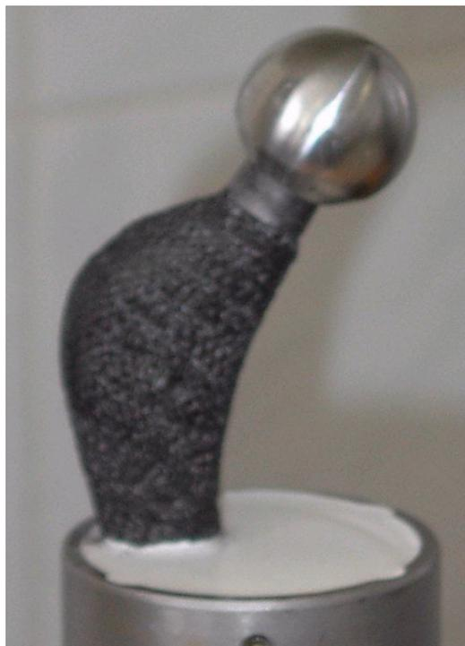
Рис. 1. Образец для статических и усталостных испытаний
