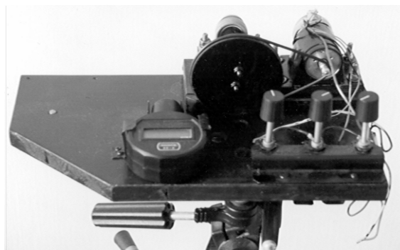
Рис. 3. Прибор, сфотографированный без камеры и вращающегося диска. Камера прикрепляется с помощью болта, который виден на левой части платформы
