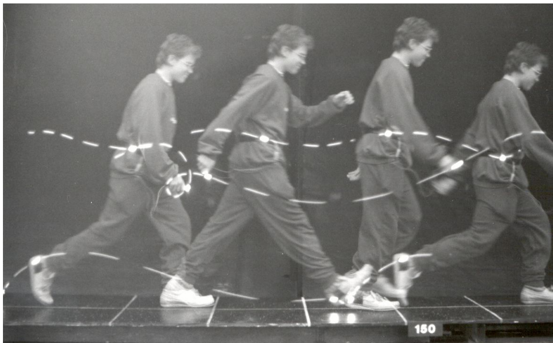
Рис. 7. Фотография, полученная с помощью диска с пятью фильтровыми апертурами. Испытуемый проходит тестовую точку
