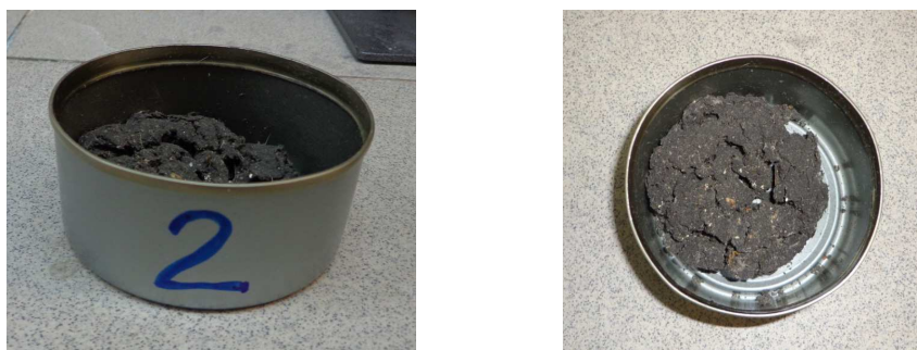
Рис. 8. Образец осадка после высушивания до постоянной массы (абсолютно сухое состояние)
