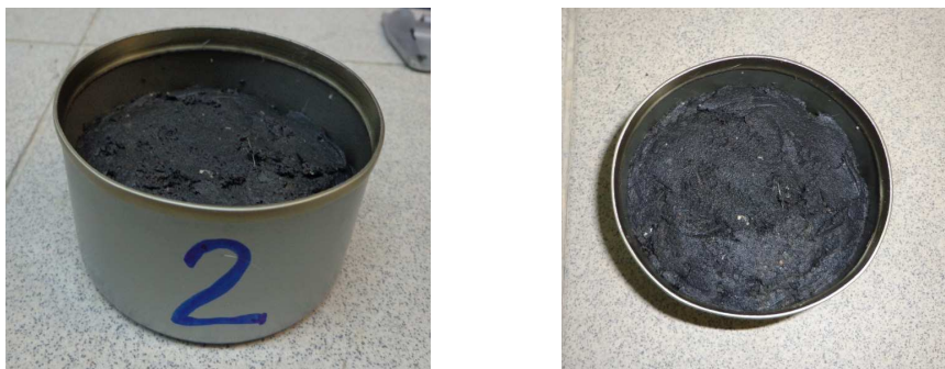
Рис. 7. Образец механически обезвоженного осадка (влажность около 80 %)
