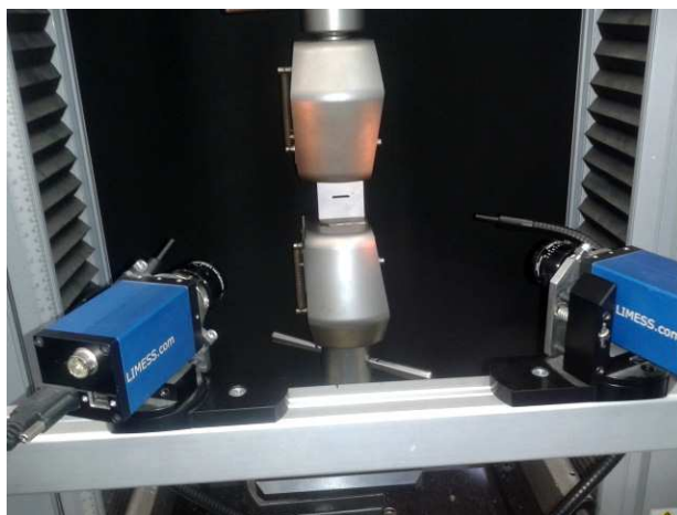
Рис. 2. Испытание на одноосное растяжение пластины с проточкой с регистрацией полей деформаций
