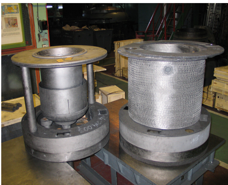
Рис. 3. Элементы теплового узла установки роста монокристаллов кремния, изготовленные из УУКМ и содержащие чашу, шток, поддон, тепловой экран
