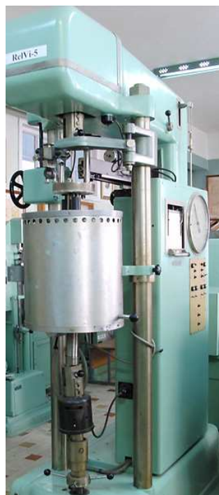
Рис. 2. Высокотемпературная печь установки «RelVi – 5»
