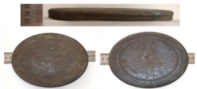
Рис. 4. Трехслойный диск: сталь – карбид вольфрама – сталь
