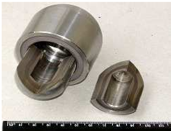
Рис. 2. Композиционный малоразмерный контейнер для защиты от ионизирующих излучений
