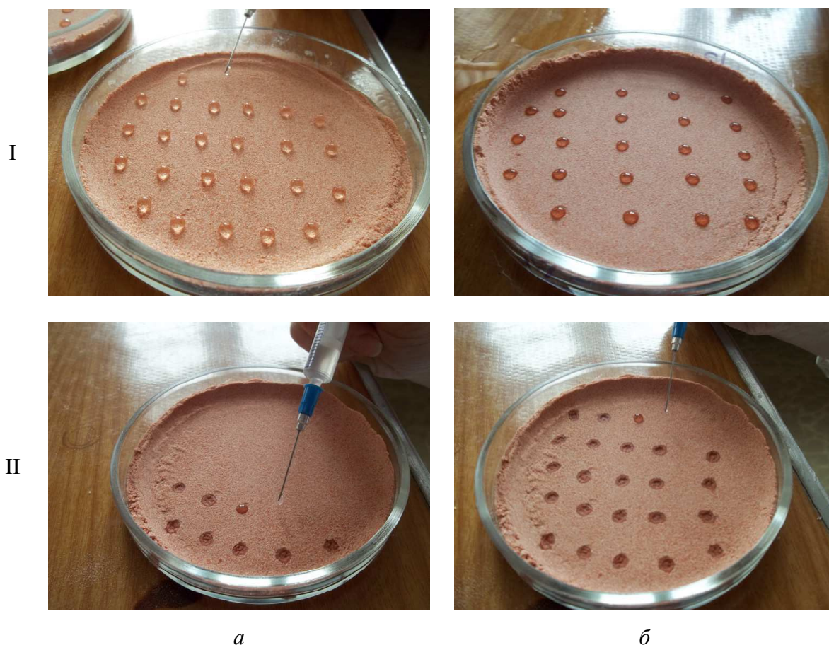
Рис. 2. Фото капель связующего на поверхности образца флотационного хлорида калия в начальный момент времени ( a ) и через 20 мин ( б ). Вид связующего: I – вода, \text{Na}_3\text{PO}_4 , (\text{NH}_4)_2\text{SO}_4 ; II – метасиликат натрия
