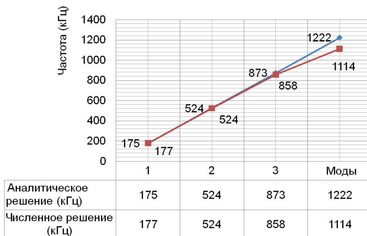
Рис. 4. График сравнения данных для тефлона: — аналитическое решение (кГц); — численное решение (кГц)
