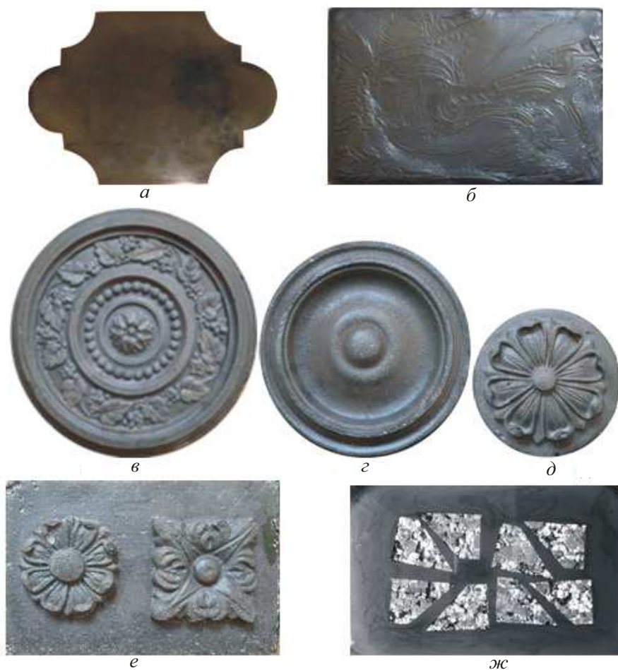
Рис. 1. Облицовочные изделия из симиналов: а – полированная плитка из симинала на основе базальта (200×120×15); б – неполированная плитка из симинала на основе горнблендита (200×100×15); в , з , д – розетки, полученные литьем в песчаную форму из симинала на основе горнблендита (Ø 300, Ø 230, Ø 120); е – рельефная плита, полученная литьем в разовую песчаную форму из симинала на основе горнблендита (200×100×15); ж – полированная плитка из симинала на основе горнблендита со вставками из натурального гранита (200×100×15) [5]
