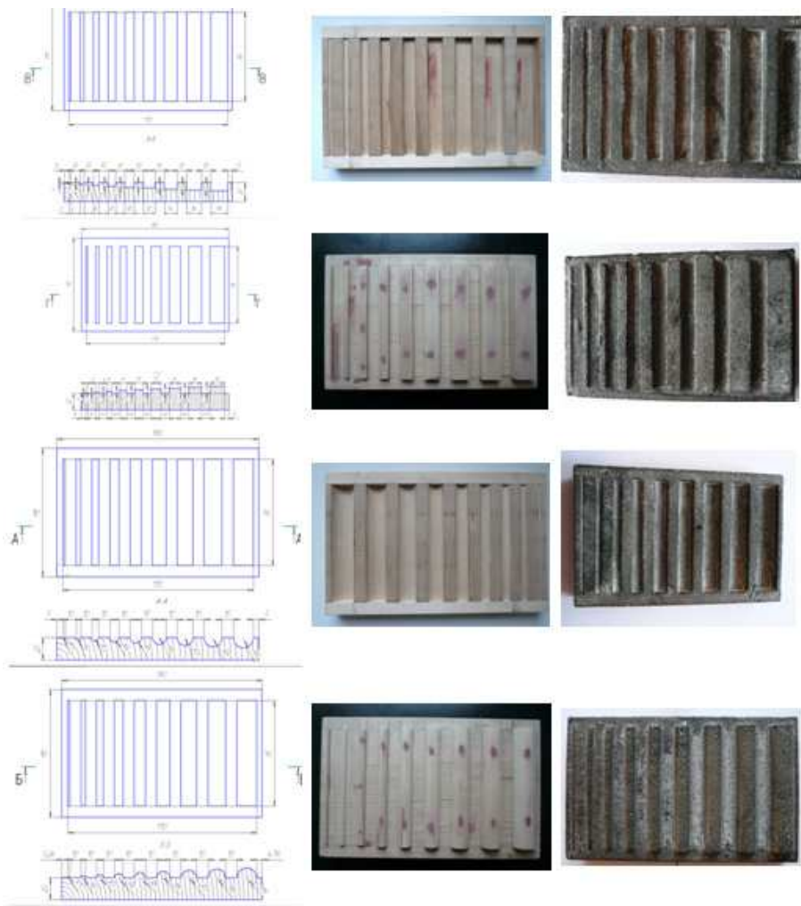
Рис. 5. Чертежи моделей и образцы для проведения оценки рельефа
