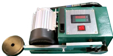
Рис. 3. Машина фрикционного изнашивания
