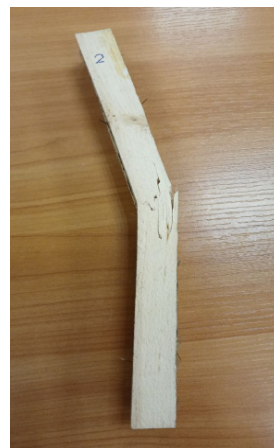
Рис. 3. Характер разрушения образцов: а – образец без фибры; б – образец с фиброй
