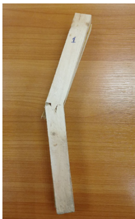
Рис. 3. Характер разрушения образцов: а – образец без фибры; б – образец с фиброй
