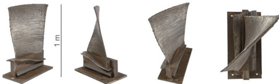
Рис. 2. Крупногабаритные детали, выращенные с использованием технологии электронно-лучевого выращивания [9]
