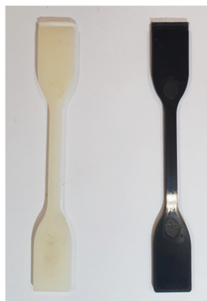
Рис. 2. Лопатки для механических испытаний, полученные с помощью ТПА: исходный АБС-пластик (слева) и композит на его основе (справа)
