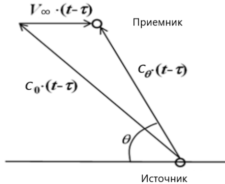
Рис. 5. Схема влияния конвекции на расчет запаздывающего времени
