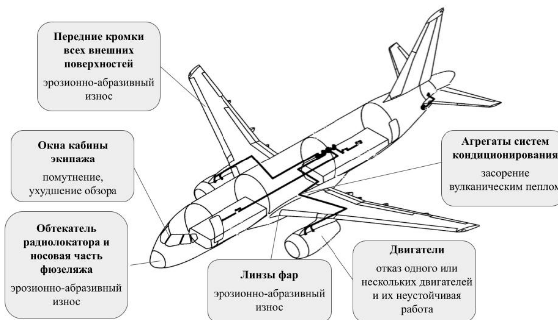
Рис. 2. Воздействие вулканического пепла на элементы летательного аппарата
