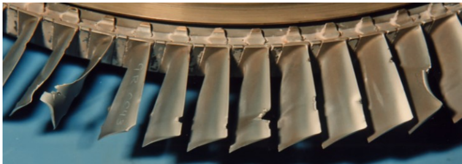
Рис. 6. Повреждения рабочих лопаток девятой ступени компрессора двигателя PW F100 при испытаниях корпорации Calspan [8]
