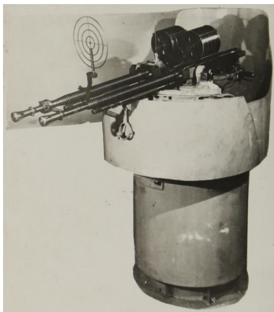
Рис. 1. 2У-К. Морская спаренная зенитная крупнокалиберная установка для 12,7-мм пулемета обр. 1938 года [8, л. 20]
