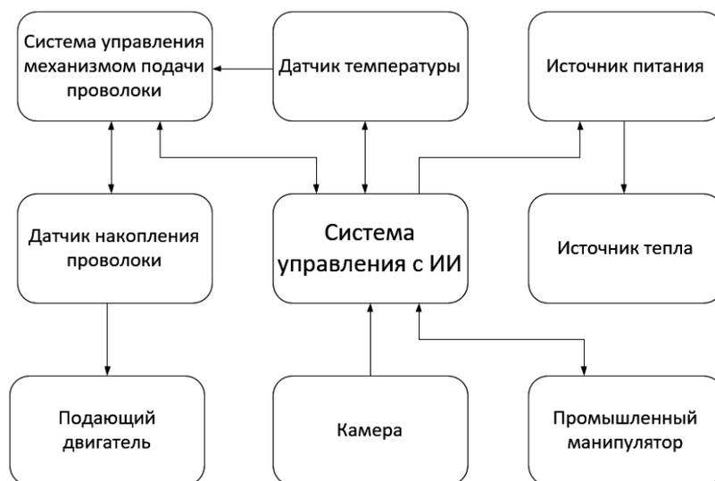
Рис. 6. Модифицированная структурная схема 3D-принтера для системы трехмерной печати металлами
