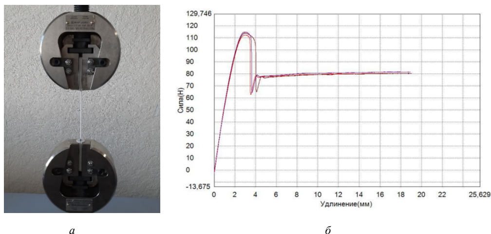
Рис. 13. Испытание образца филамента: a – установленный в испытательной машине с помощью оснастки образец; б – график зависимости между нагрузкой и деформацией для установленного образца
