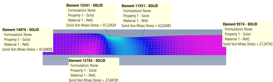
Рис. 11. Распределение эквивалентных напряжений в окрестности границы между свободным участком филамента и участком в оснастке
