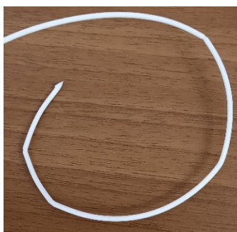
Рис. 3. Состояние филамента PetG после накручивания его на барабан диаметром 30 мм
