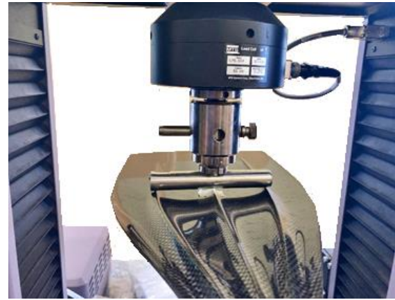
Рис. 5. Лопать весла и индентор для приложения нагрузки F_3^a в точке D , закрепленный в захвате испытательной машины MTS Criterion 43
