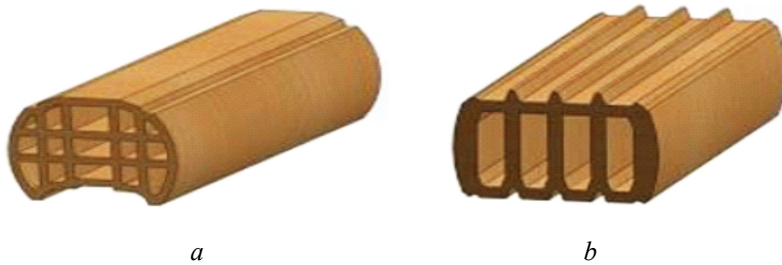
Рис. 2. Строительные конструкции из полимерных композиционных материалов: a – бревно; b – брус
