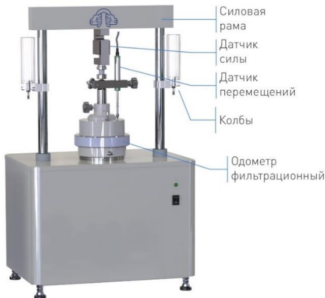
Рис. 1. Прибор компрессионного сжатия ГТ 1.1.10
