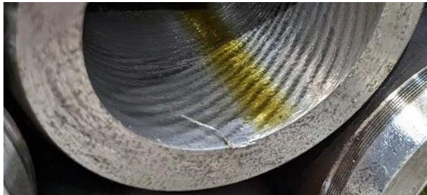
Рис. 4. Огранка в обработанном отверстии
