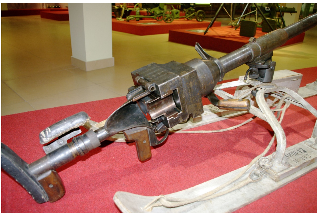
Рис. 5. Клиновой затвор ружья РЕС, хранящегося в Музее Отечественной военной истории (фото автора)
