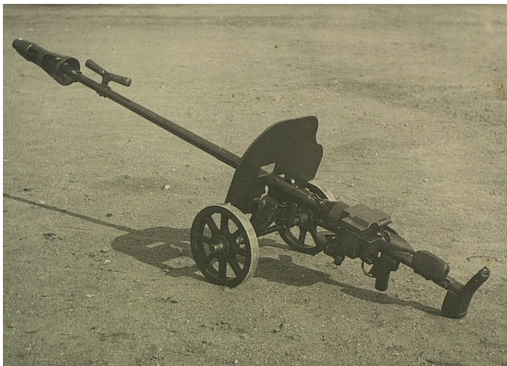
Рис. 4. Ружье РЕС с окончательно принятым для серии дульным тормозом (ЦАМО РФ)
