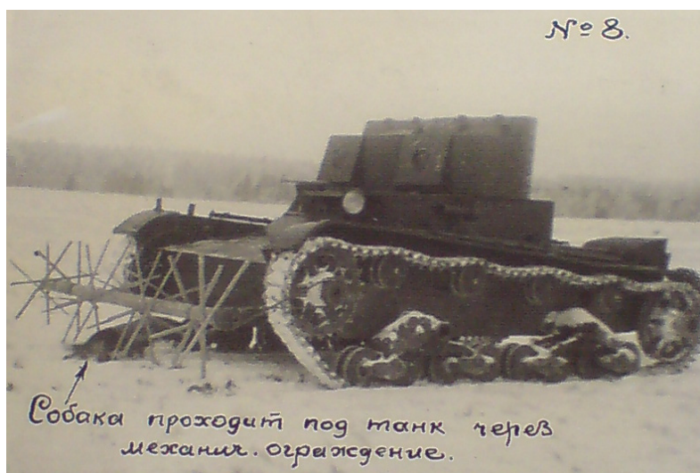
Рис. 8. Испытание механического заграждения танка Т-26 для защиты от собак-истребителей, предложенное начальником научно-испытательного танкового полигона т. Воробьевым [2, л. 87]
