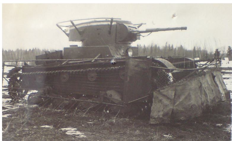
Рис. 6. Испытание защитных экранов танка Т-26, препятствовавших их подрыву собаками [2, л. 65]
