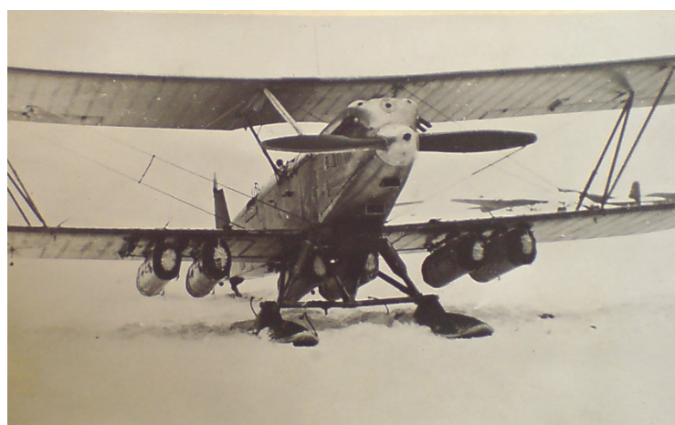
Рис. 3 Самолет Р-5 с подвешенными на него транспортными коробами с собаками внутри [2, л. 6]
