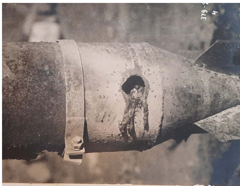
Рис. 16. Корпус зажигательной авиационной бомбы с отверстием, прожженным ГЗС-7 [9, л. 3]
