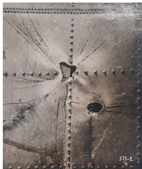
Рис. 15. Дюралевое покрытие самолета, прожженное снарядом ГЗС-7 [9, л. 4]
