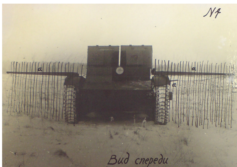
Рис. 9. Испытание электрифицированного заграждения двухбашенного танка Т-26 для защиты от собак-истребителей, разработанное специалистами Военной электротехнической академии [2, л. 76]
