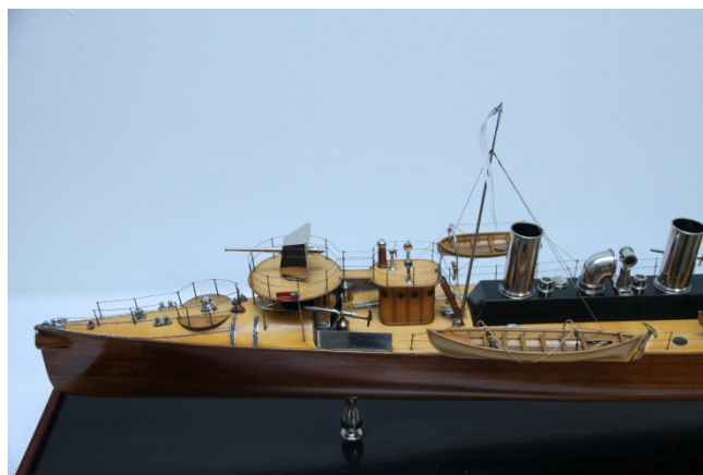
Рис. 6. Носовые орудия и якорное устройство на модели миноносца «Буйный». ЦВММ Инв. № 06М-859
