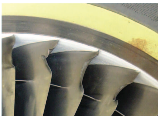
Рис. 1. Повреждение рабочих лопаток вентилятора двигателя ПС-90А от попадания птицы [1]
