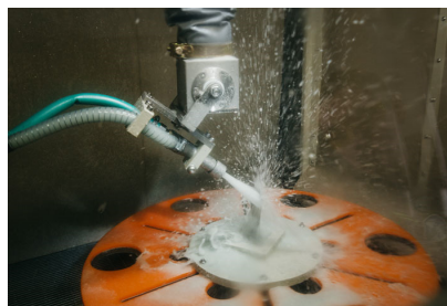
Рис. 6. Процесс гидродробеструйного упрочнения
