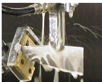
Рис. 4. Процесс малопластичного выглаживания
