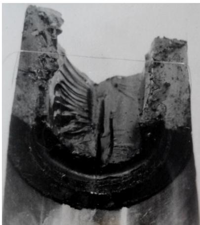
Рис. 3. Вид шламовых отложений в роторе центрифуги КамАЗ, отработавшего 8000 км на смешанном масле: 85 % М10Г<sub>2</sub>К + 15 % SAE 5W-40
