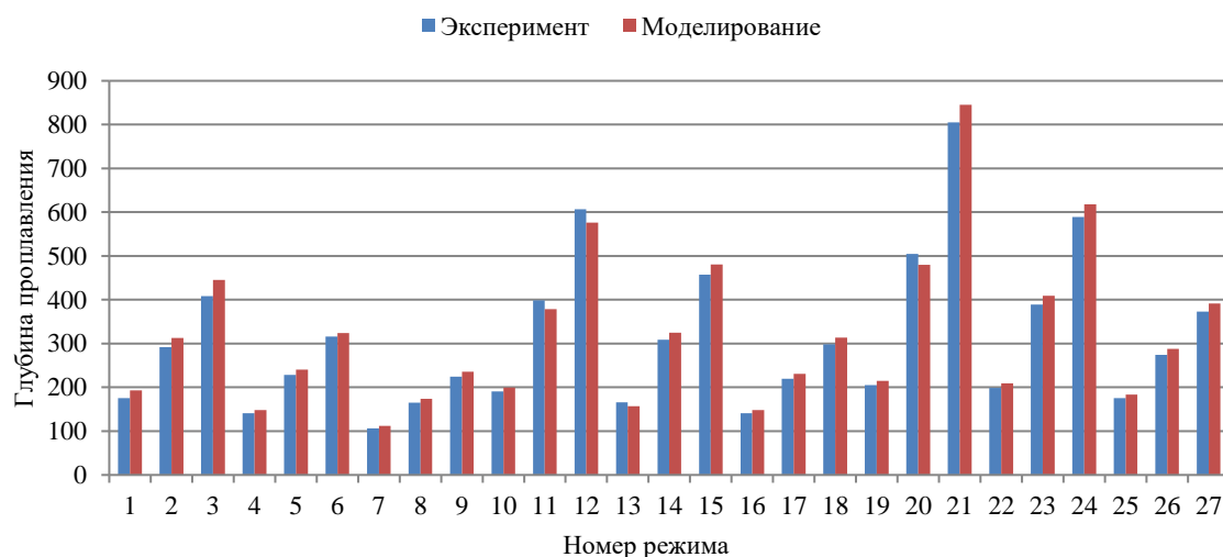
Рис. 9. Результаты сравнения глубины проплавления при эксперименте и моделировании
