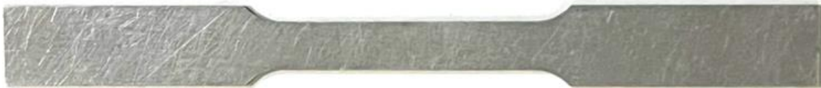
Рис. 7. Стандартный образец для испытания на растяжение в соответствии со стандартом ASTM E8/E8M - 13a [17]
