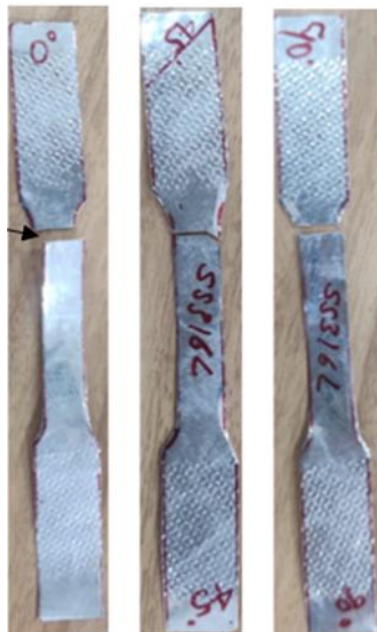
Рис. 8. Испытание на растяжение тонкой фольги SS316L
