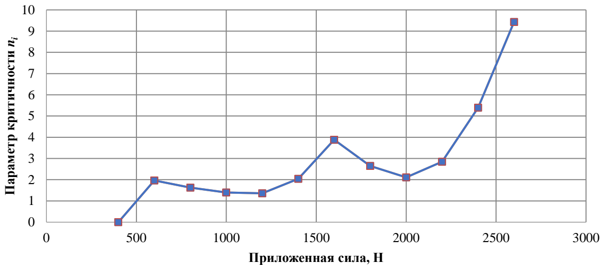
Рис. 5. Значения параметра критичности n_i тканого УУКМ при испытаниях на одноосное сжатие (образец № 6)
