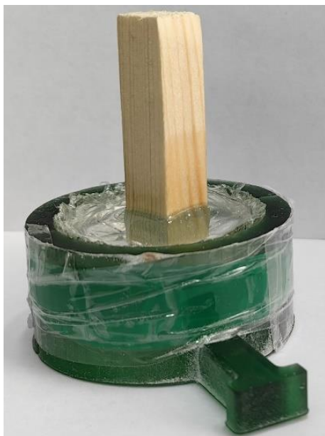
Рис. 2. Разъемная форма для подготовки образцов и образец, закрепленный с помощью эпоксидной смолы
