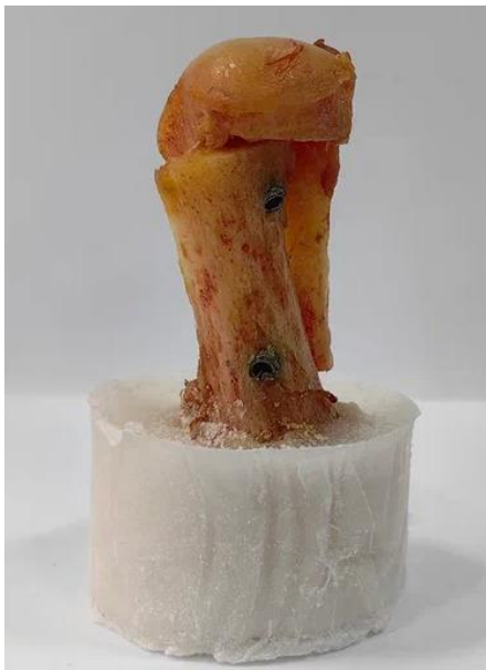
Рис. 7. Образец первой плюсневой кости с выполненной остеотомией типа scarf , закрепленный одним концом с помощью цианоакрилатного клея
