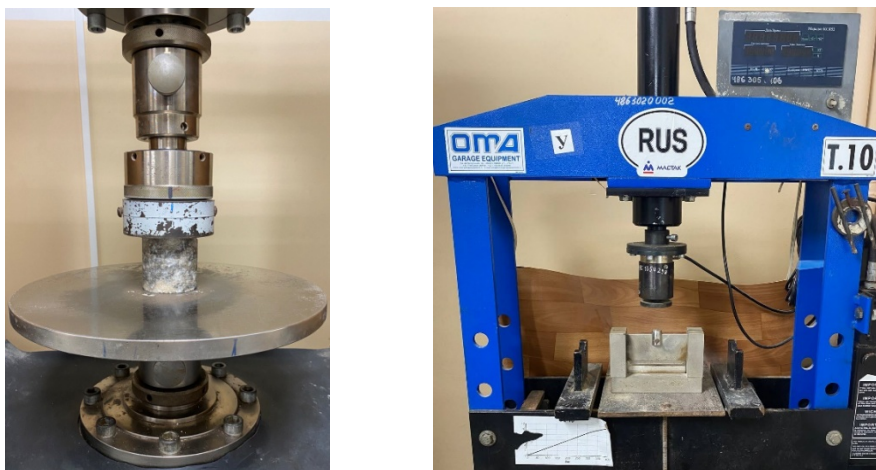
Рис. 2. Оборудование для проведения лабораторных испытаний: а – электромеханический пресс Zwick/Z250 (одноосное сжатие); б – ручной гидравлический пресс Т.10 (одноосное растяжение)
