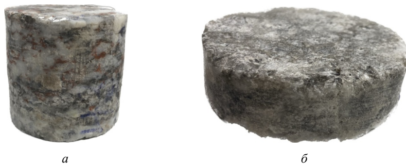
Рис. 1. Образцы горных пород, предназначенные для испытаний на сжатие ( а ) и растяжение ( б ) методом раскалывания
