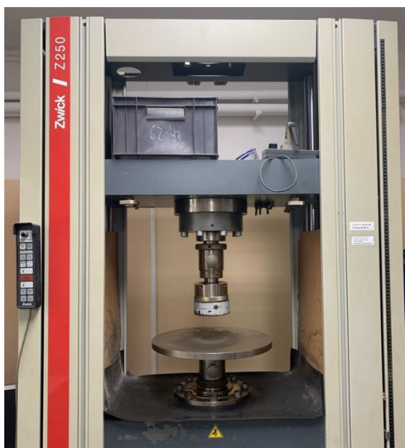
Рис. 1. Лабораторное оборудование для проведения испытаний на одноосное сжатие (электромеханический пресс Zwick/Z250)
